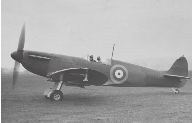
Spitfire Mk.I rané produkce, s dvoulistou dřevěnou vrtulí Weybridge, starším typem anténního stožárku a Pitotovy trubice, bez jakéhokoli pancéřování, bez vytápění kulometů, s původním plochým krytem kabiny a mechanickými miřadly.
