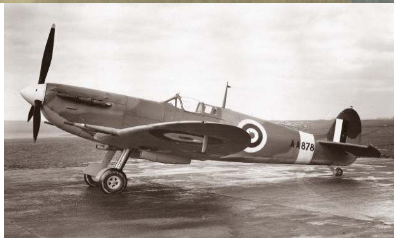
Spitfire Mk.Vc vyzbrojený čtveřicí kanónů Hispano Mk.II. Vrtule je De Havilland, překryt kabiny nového stylu s vnitřním pancéřovým čelním štítkem a posuvným překrytem s vybořenými boky. Zdá se, že tento letoun je vybaven starším typem rádia Tr.9D.
