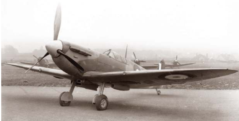
Spitfire Mk.V z rané produkce vyrobený v říjnu 1941 se symetrickými spodními boulemi pod kanonovými šachtami, zvětšeným chladičem a starším typem překrytu kabiny s vnějším pancéřováním. Letoun ještě nemá výzbroj a je vybaven vrtulí De Havilland a novějším typem rádia Tr1133.
